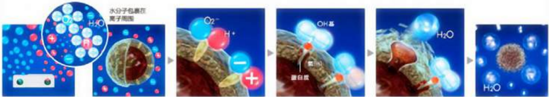
利用「净离子群」进行空中除菌的机制 (示意图)
